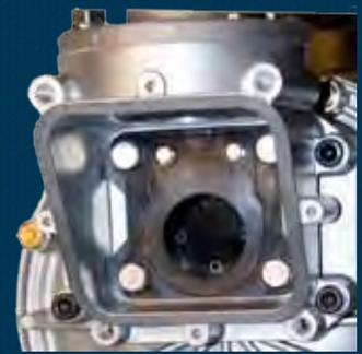
4 Schrauben öffnen, um Zugang zum Klappenventil zu bekommen.
